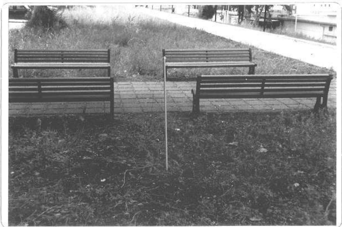
tubo piezometrico inserito in foro penetrometrico
